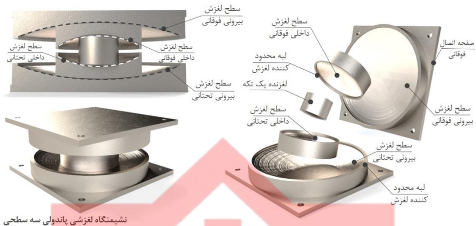
شکل (۳-۲۱). جزئیات نمونه‌ای از نشیمنگاه‌های لغزشی سه پاندولی
